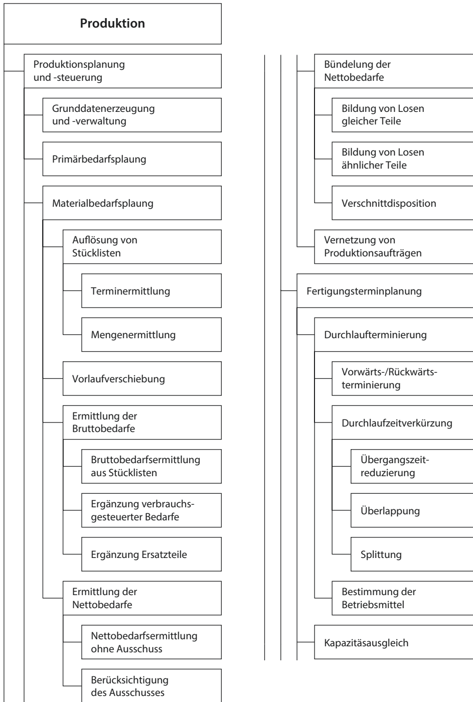
■ Abb. 4.4 Funktionsmodell des Produktionssektors (Ausschnitt) (s. ► Abschn. 4.4.1.3 )
