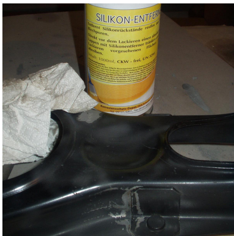
Säubern und Entfetten des Achsträgers, z.B. mit Silikonentferner
