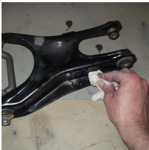
Überschüssiges Owatrol Öl abwischen, da es auf den blanken nicht saugfähigen Flächen keinen ordentlichen Haftgrund bildet. Ca. 24 Stunden trocknen lassen
