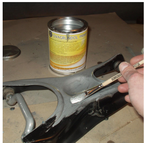
2-3 Mal mit Ovagrundol streichen. Jeweils 6-24 Stunden oder länger Zwischentrocknungszeit lassen. (Alternativ YC Unterwasserprimer verwenden)
