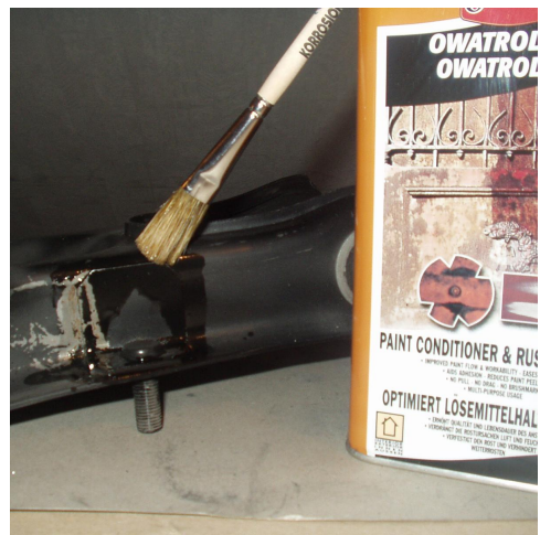
Restrost mit Owatrol Öl sättigen, bei überwiegend blankem Blech und nur eher Flugrost besser Fertan oder BOB 1 einsetzen. Falze mit Owatrol Öl zulaufen lassen und versiegeln.
