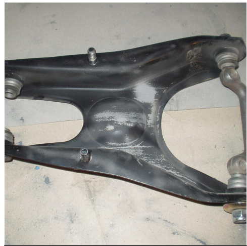
Anschleifen bzw. Anstrahlen des Altlacks, wobei nicht haftende Lackpartikel gelöst werden und Rost weitestgehend beseitigt wird.
