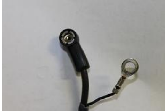
Abbildung 1: Original-Antennenleitung SLCM ↔ Heckscheibe: FME-Steckverbinder (links) und gecrimpte Ringöse für den Scheiben-Druckknopf (rechts). Quelle: Jaguar Forums, Thread "How to remove memory from key fob" .
